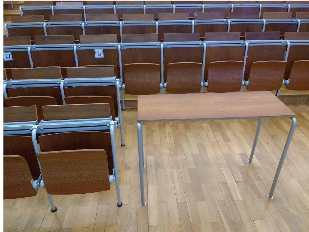
Zentraler Platz für Rollstuhlbenutzer im Hörsaal HE101 mit eingebautem Tisch im Design des Hörsaals
